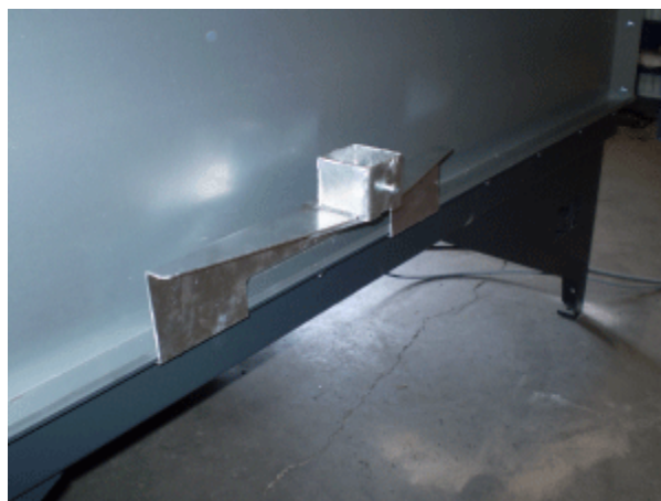
Nederste beslag til hejs monteret på midten af siloen i samlingen mellem silobund og første sektion
