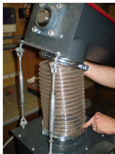
Bardunstrammere monteret mellem snegl og celledluse.
