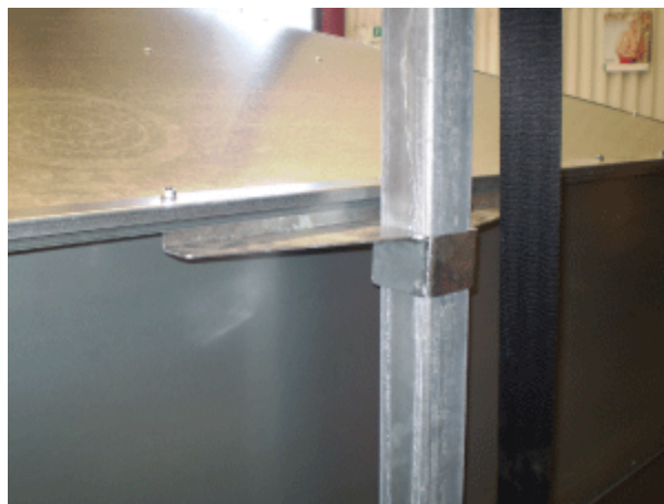
Øverste beslag monteret sammen med nederste del af hængslet til låget
