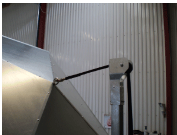
Toppen af søjlen med krog monteret i øjebolten. Bemærk hvordan top med rulle vender i forhold til låget.
