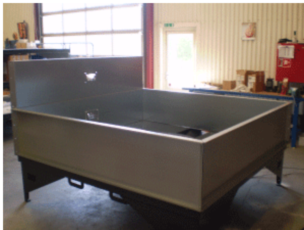
Silobund med første sektion + en plade af næste sektion monteret.
