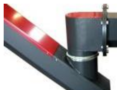
Transportsnegl fastgøres til udløb med medsendt lynkobling
